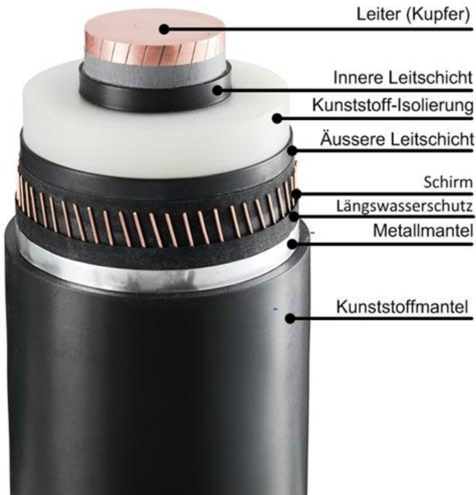
Abb. 3-2: Beispielhafter Kabelaufbau (Quelle: Broschüre Hochspannungskabel von ABB, Stand 01/2015)
