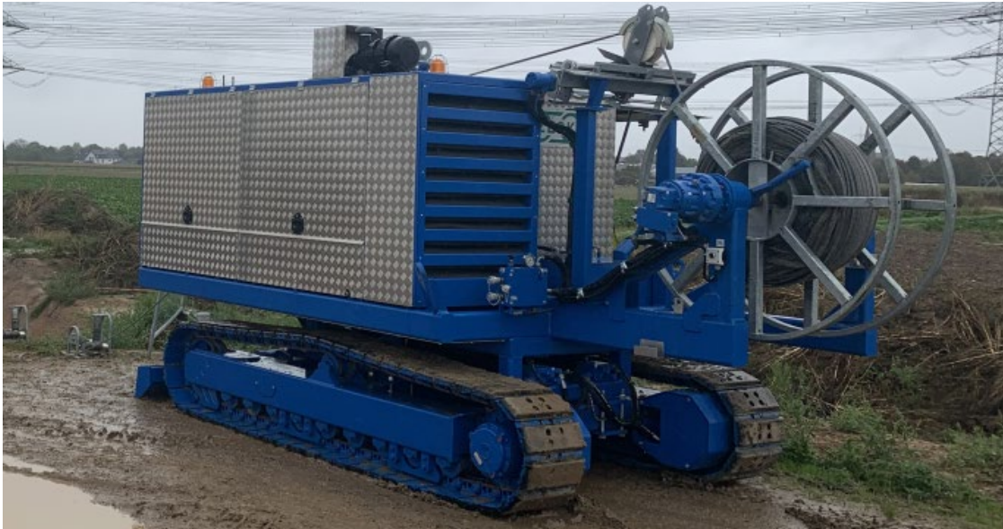
Abb. 4-14: Beispiel für ein Kabelzuggerät auf selbstfahrendem Raupenfahrwerk
